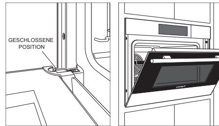
Scharnierriegel der Backofentür Tür in Ruheposition
